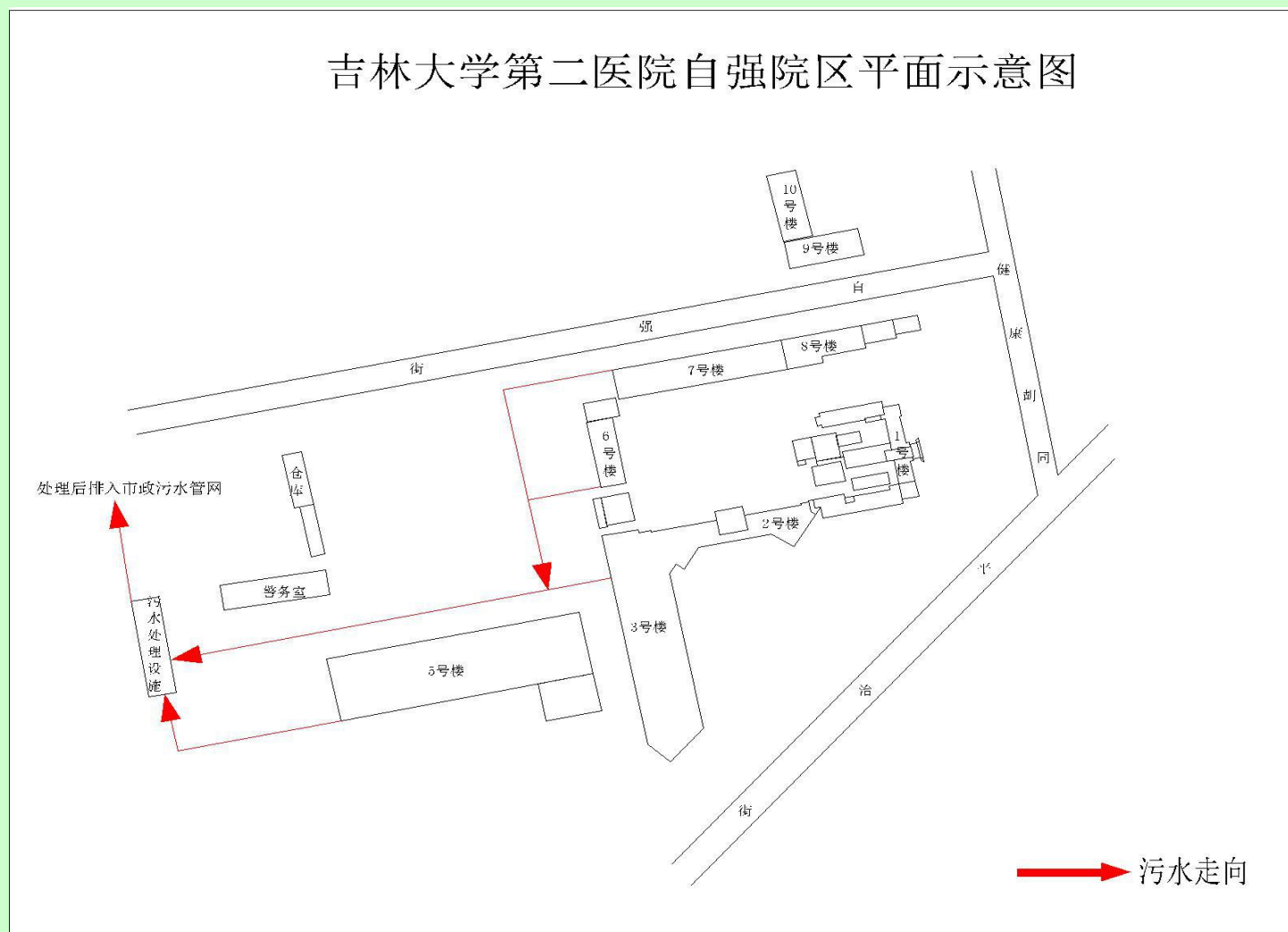
本项目雨污水管网图
